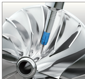
테이퍼 엔드밀 가공(임펠러 가공 등) Taper Endmill Machining ( for Impeller etc)
