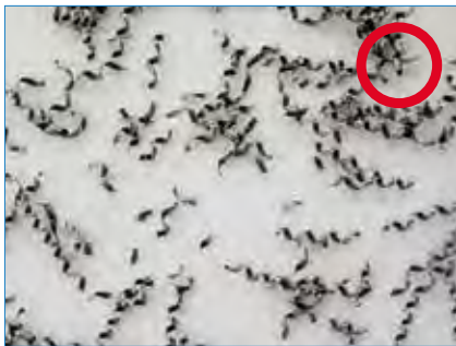
브레이커 있음 (HH브레이커)
